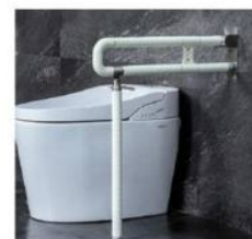
型号: 【LY104-5】 名称: U型落地扶手 材质: 201不锈钢管+ABS 尺寸: 750 \times 80 \times 600 承重: 150kg 颜色: 黄 / 白
