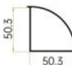
JH-5090 90度转角 | 90 Degree Corner Profile 壁厚THK: 1.35 MM 米重W/M: 0.686 KG/M
